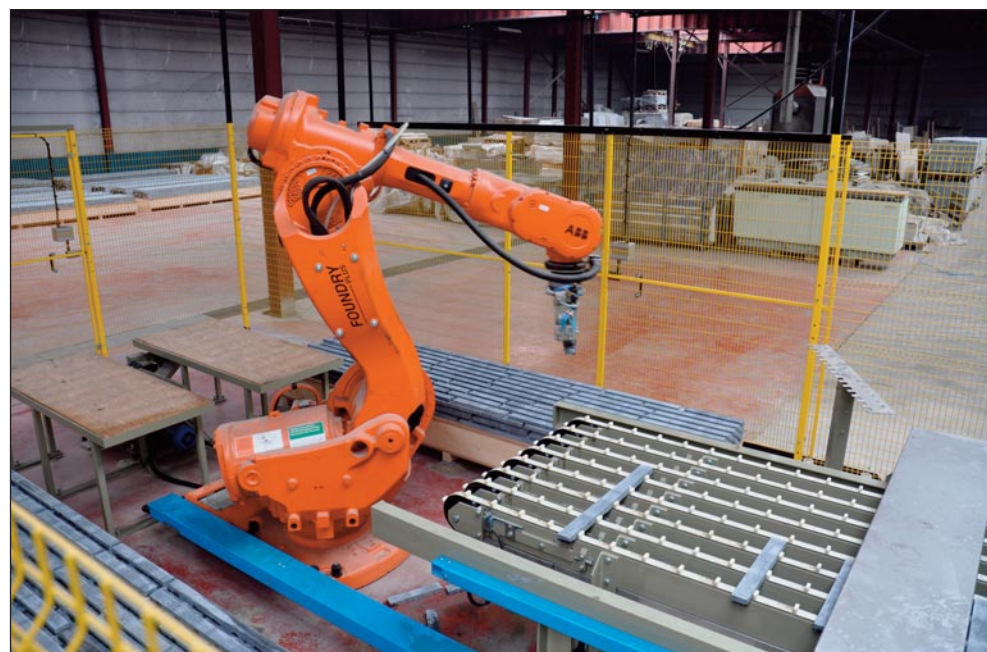
De output van de lijn loopt via een automatisch meetsysteem naar een robotcel waar een ABB-robot de strips klaar legt op palletten.
